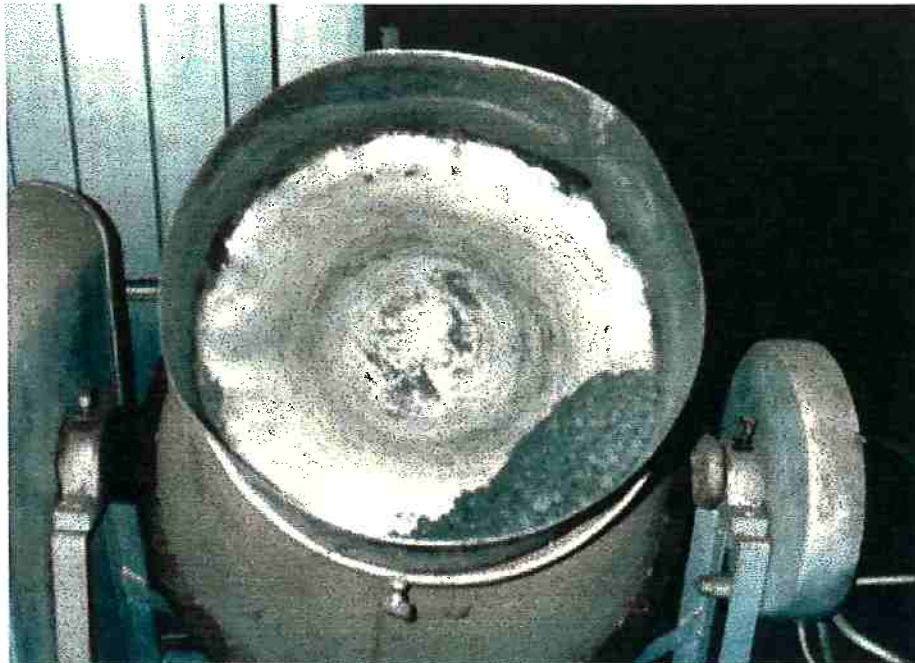
Figura 11: Disco Pelotizador utilizado [8] .
