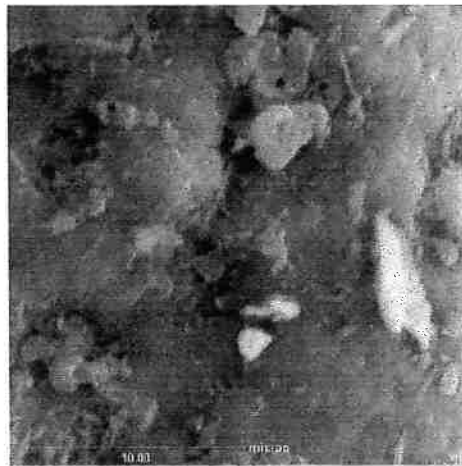
Figura 25: Micrografia de uma pelota com 7,5% de teor de cimento ARI. Aumento de 5000x.
